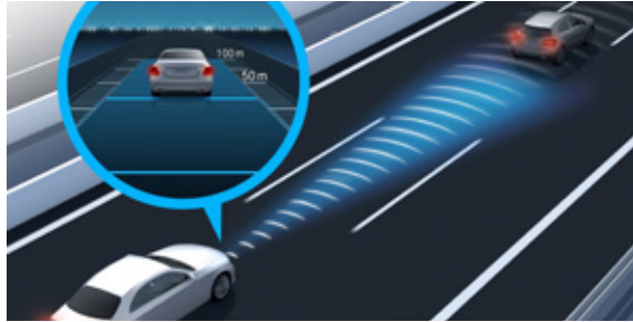
ระบบช่วยรักษาระยะห่างจากรถคันหน้า (Active Distance Assist DISTRONIC)*
