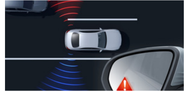
ระบบช่วยเตือนขณะเปลี่ยนช่องจราจร (Blind Spot Assist)
